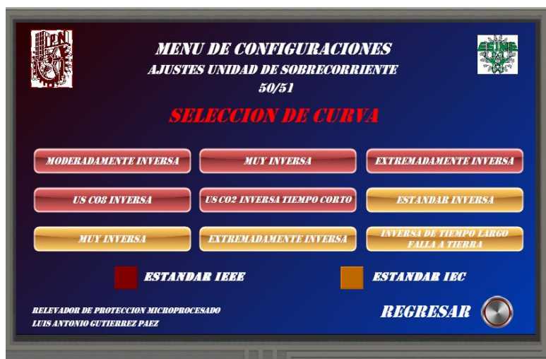
Figura 4. 28. Submenú de la selección de la curva característica.
