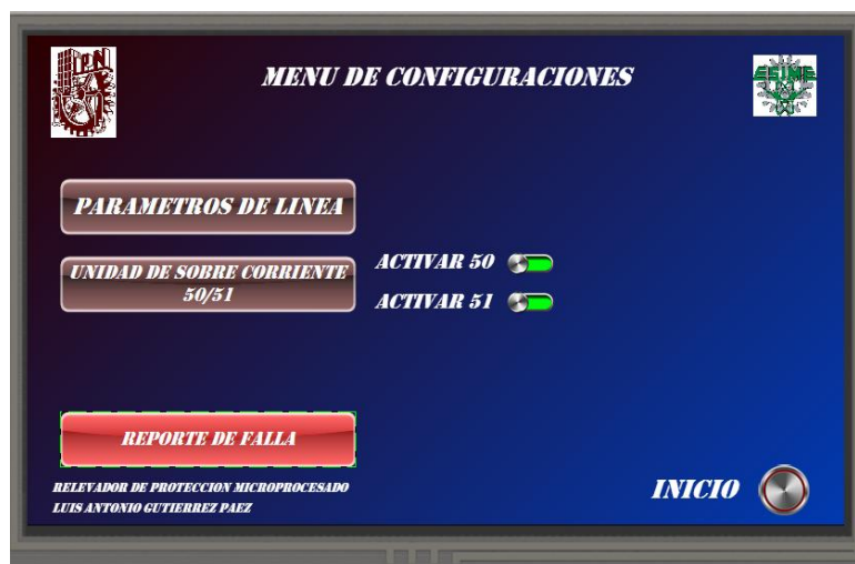
Figura 4. 24. Menú de configuraciones del relevador.
