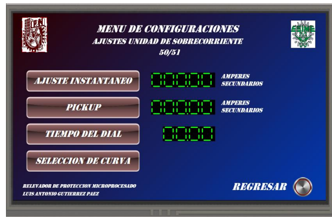
Figura 4. 27. Submenú de configuraciones de las unidades de protección de sobrecorriente.
