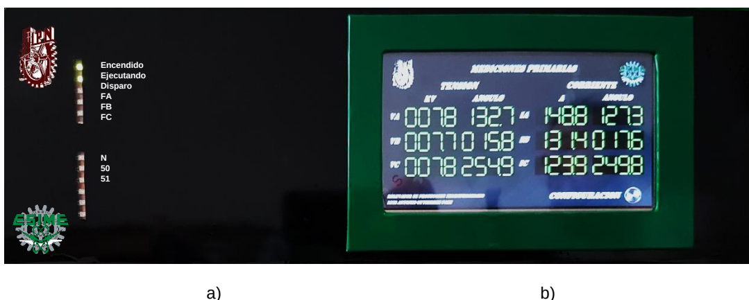
Figura 4. 20. Panel frontal del relevador, a) Sistema de señalización, b) HID.
