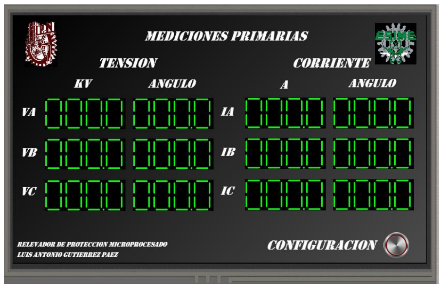
Figura 4. 23. Panel principal de mediciones fasoriales.
