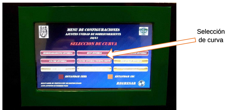
Figura 5. 19. Selección de la curva característica "Muy inversa" del estándar IEEE.
